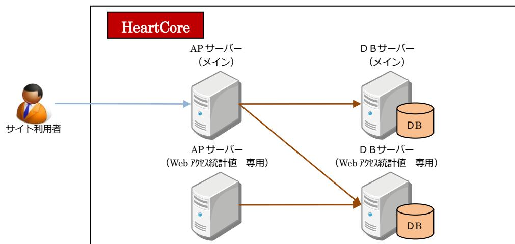
Web アクセス統計値を分離した構成です。Web アクセス統計値データだけは別のデータベースサーバで管理しています。また Web アクセス統計値を参照する際の専用のアプリケーションサーバを用意することで、統計値出力処理時のメイン HeartCore へのパフォーマンス劣化の影響を防ぐことができます。
